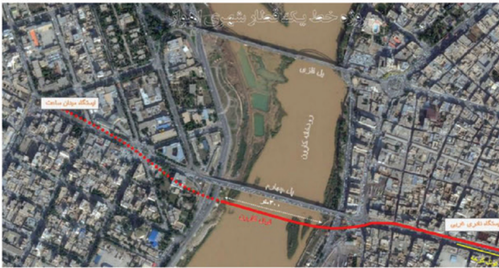
شکل ۴ - مسیر انتخابی برای عبور تونل از زیر رود کارون
