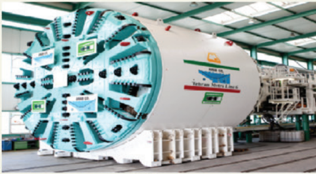
شکل (۱) تصویر ماشین EPB خط ۶ متروی تهران
