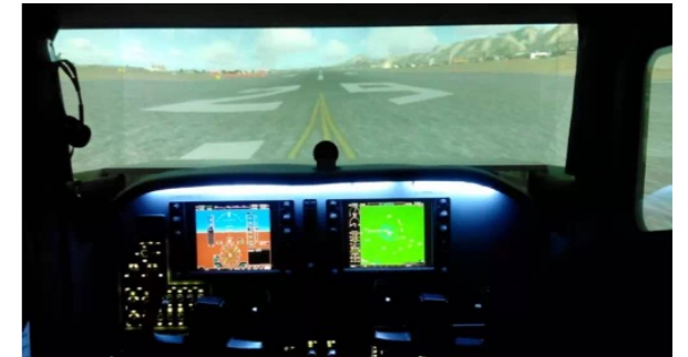
طراحی و ساخت دستگاه شبیه ساز پرواز (سنا ۱۷۲)
