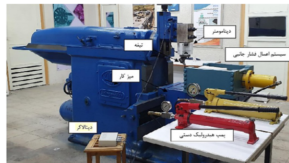
طراحی و ساخت ماشین برش خطی سنگ
